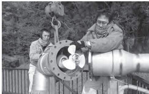
黒保根浄水場に設置された小水力発電機
